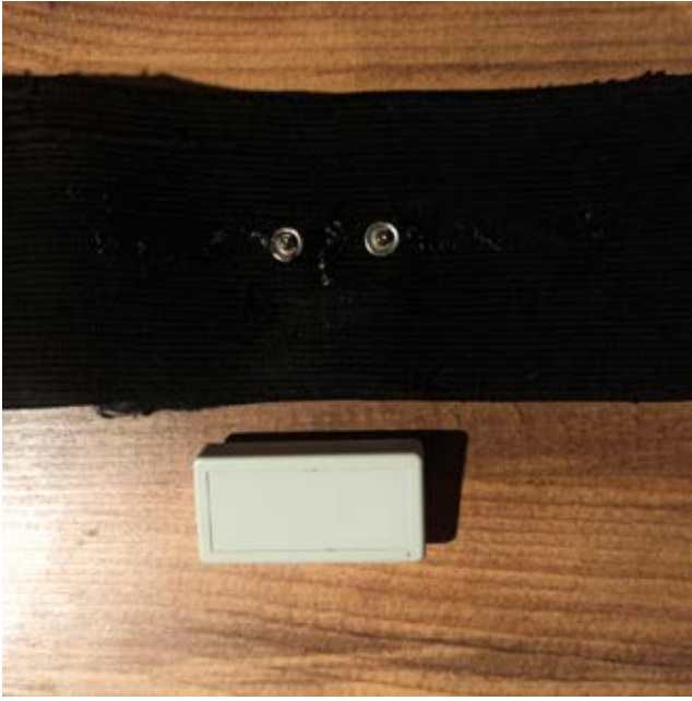
Şekil 3: Geliştirilen cihaz ve tekstil elektrotlu bandaj görseli.
