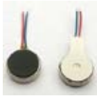
Şekil 3. Şaftsız Titreşim Motoru [17]
