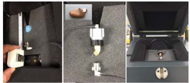
Şekil 2. İşitme cihazının akustik kabin içerisindeki bağlantısı
