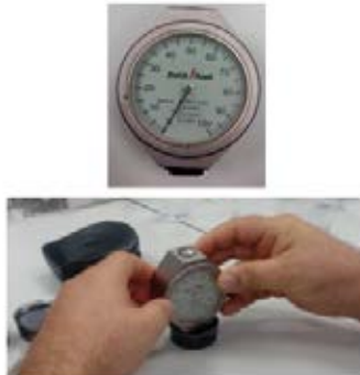
Şekil 1. Zwick Roeli marka Shore A sertlik ölçüm cihazı ve cihaz ile numunelerin ölçümünün alınması
