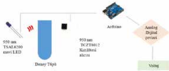
Şekil 2. Girişimsel Olmayan Glikoz İzleme Deney Düzenine Şematik Gösterimi
