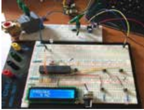
Şekil 6. Pedal-tetik devresi ve solenoid valf sürücü devre
