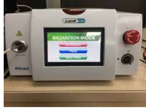
Şekil 2: Lazer cihazının modları
