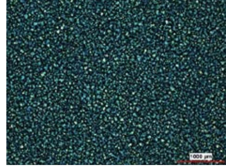
Şekil 2: Kaplanmış sensörün elektron mikroskobu altındaki yüzey fotoğrafı
