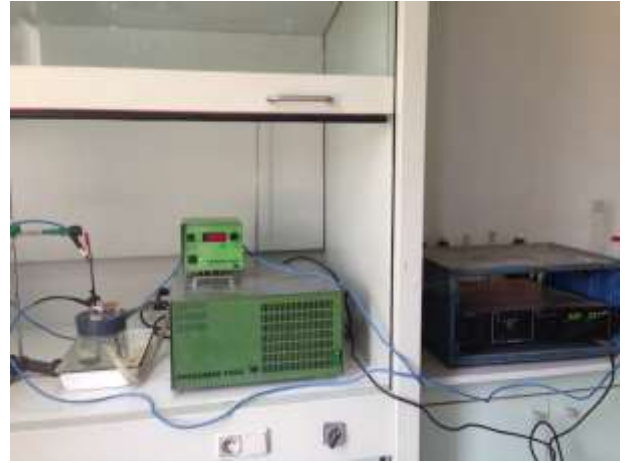
Şekil 1: Sabit voltaj kaynağı, ısıtmalı sirkülasyonlu su banyosu içeren deney düzeneği.
