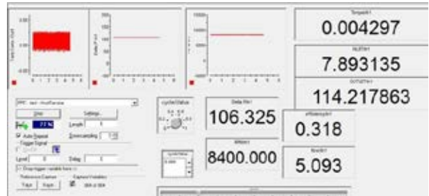
Şekil 5: dSPACE ekranı (8400 devir, 5 lt/dk debi ve 106 mmHg basınç %31 verimlilikle üretilirken)
