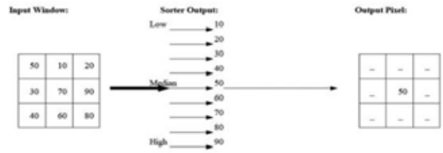
Şekil 3: Ortanca filtrenin çalışma mekanizması [13]
