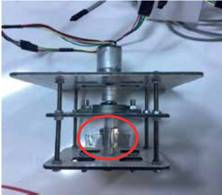
Şekil 5. Mevcut sisteme metal plaka eklenmiş hali
