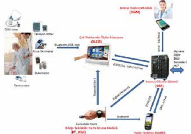
Şekil 1: Uçtan Uca Uzaktan Hasta Takip Sistemi (ALTHİS) Mimarisi
