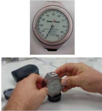
Şekil 1. Zwick Roeli marka Shore A sertlik ölçüm cihazı ve cihaz ile numunelerin ölçümünün alınması
