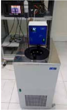
Şekil 1. Özel olarak üretilen kararlı sıcaklık banyosu
