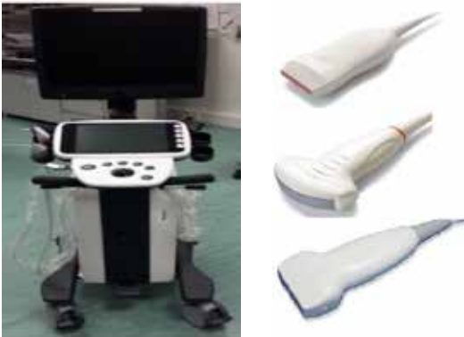
Şekil 1. Ultrasonix Sonix Touch Q+ Ultrasonografi Sistemi ve Ölçümlerde Kullanılan Çeşitli Tiplerdeki (Sektör, Konveks, Lineer) Dönüştürücüler
