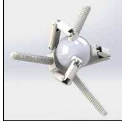
Şekil 4. El üzerine monte edilmiş yumuşak parmakların (açık vaziyette) konsept görüntüsü.
