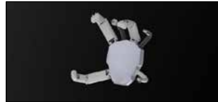
Şekil 5. Yumuşak parmakların yerine takılmış farklı cihazlardan oluşan tasarım.
