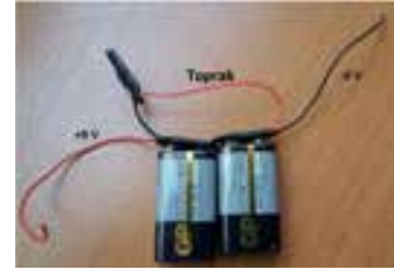
Şekil 2: Gerilim kaynağı ve bağlantısı
