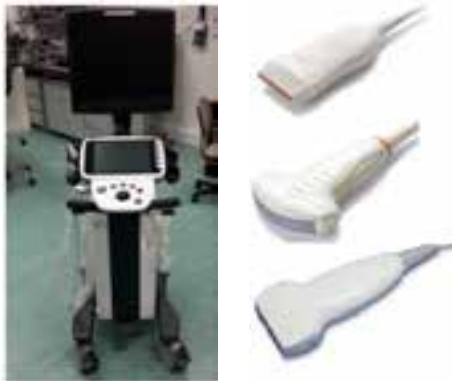
Şekil 1. Ultrasonix Sonix Touch Q+ Ultrasonografi Sistemi ve Ölçümlerde Kullanılan Çeşitli Tiplerdeki (Sektör, Konveks, Lineer) Dönüştürücüler
