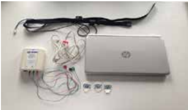
Şekil 1. EGG cihazı ve kayıt düzeneği
