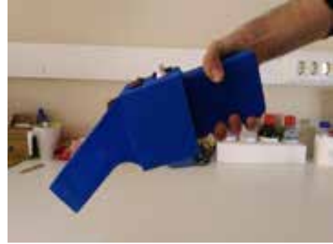
Şekil 2. 3B Yazıcı ile Üretilen Mekanik Parçaların Montajlanmış Hali
