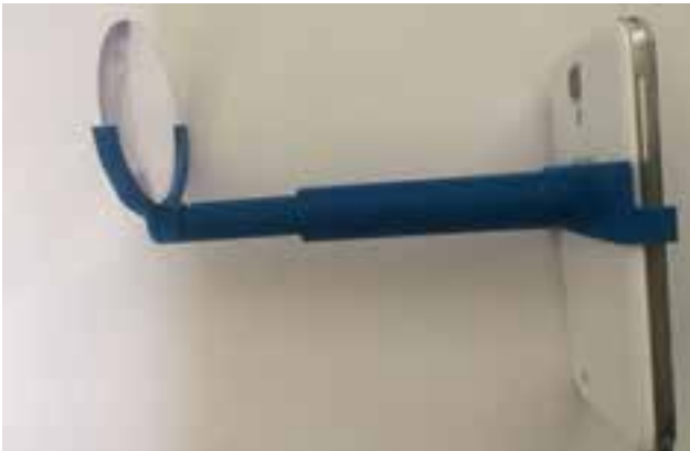
Şekil 7. Akıllı bir cep telefonuna klasik bir mercek montajı için 3 boyutlu yazıcı yardımıyla üretilen bir prototip. Bu prototip, İsa Yakup Aksoy tarafından geliştirilmiştir.
