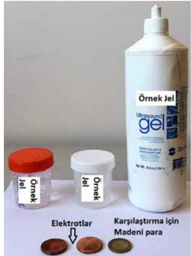
Şekil 3. Elektrot ve jel etkileşimi ile oluşturulmuş kapasite modeli
