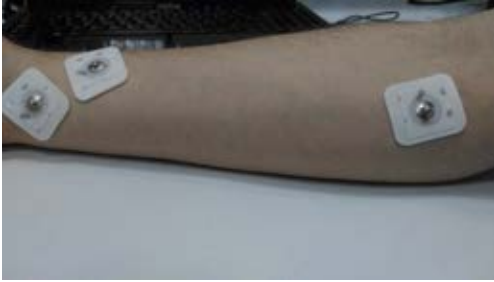
Şekil 3. Biopac MP36U EMG-I deneyi için artı, eksi ve toprak elektrotlarının bağlantısı
