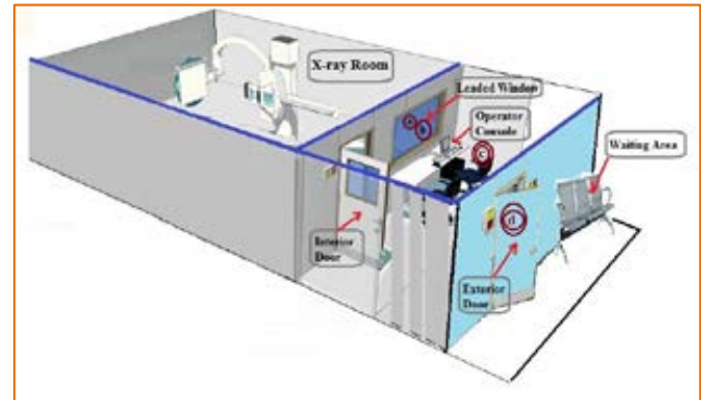
Şekil 1. Örnek bir X-ışını odası ve ölçüm noktaları.
