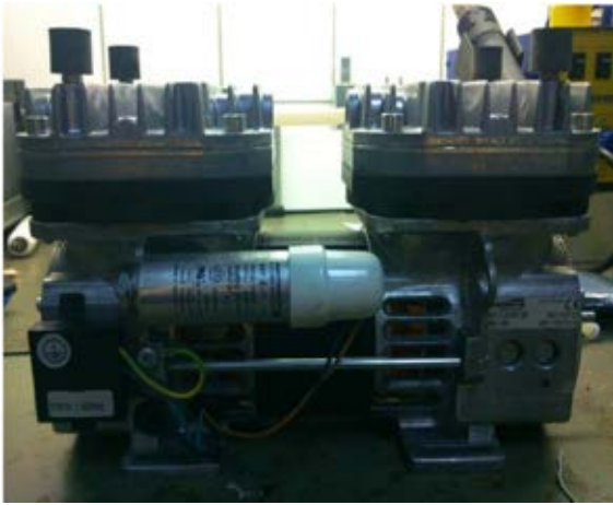
Şekil 1: Otoklavlarda kullanılan bir vakum pompası [12]
