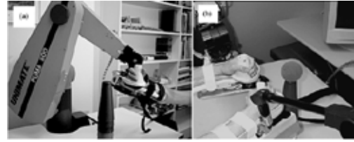
(a) Tek Taraflı Hareket (b) Çift Taraflı Hareket Şekil 4. MIME Sistemi [11]
