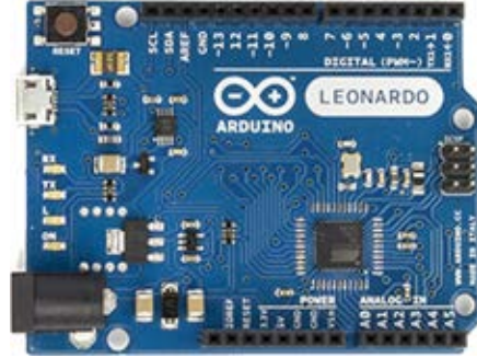
Şekil 2. Arduino Leonardo geliştirme kartı
