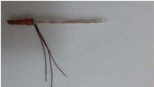
Şekil 2. Üç adet karbon fiber elektrot içeren proba ait bir resim.
