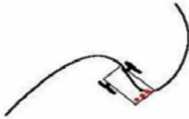
Şekil 6: Robota göre çizginin solda olması durumu [10].
