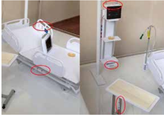
Şekil 3: Petri kapları ve indikatör kağıtlarının deney düzeneğine yerleştirilmesi
